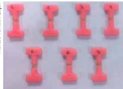
4 Kuumpolümeeriseeruvast akrüülist katsekehad.
